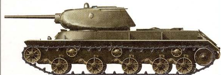
Опытный тяжелый танк ИС-1 с 76-мм гаубицей
