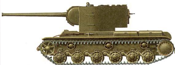
Тяжелый танк KB-2 с 152-мм гаубицей МЛ-20С
