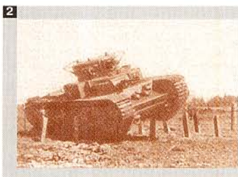
Ведущие колеса заднего расположения со съемными зубчатыми венцами. Направляющие колеса с винтовым механизмом натяжения. Подвеска — на каждом борту по четыре тележки, в каждой по два катка. Подрессоривание осуществлялось двумя спиральными пружинами.
