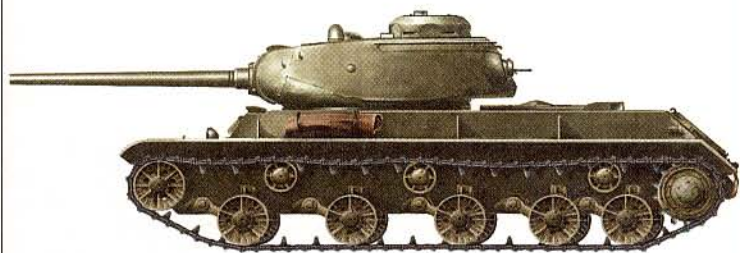
Опытный тяжелый танк ИС-1 с 76-мм гаубицей
