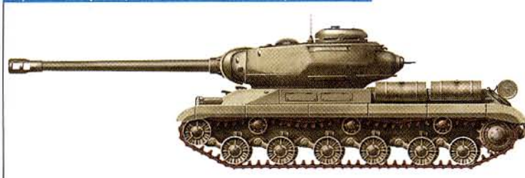
Серийный образец тяжелого танка ИС-2 образца 1944 г.
