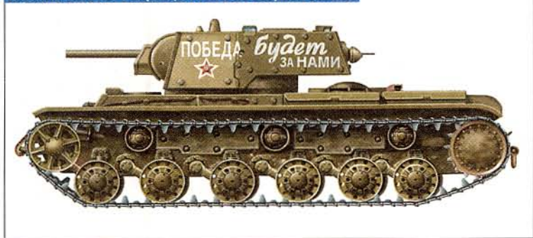
Тяжелый танк КВ-1 образца 1939 г. со сварной башней
