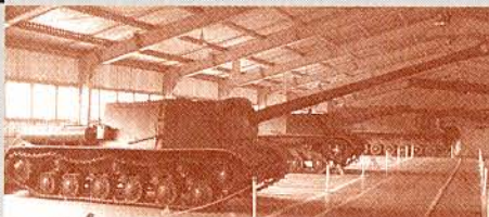
Тяжелая самоходная установка ИСУ-122 с пушкой Д-25С
