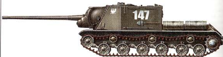
Тяжелая самоходная установка ИСУ-122 с пушкой А-19
