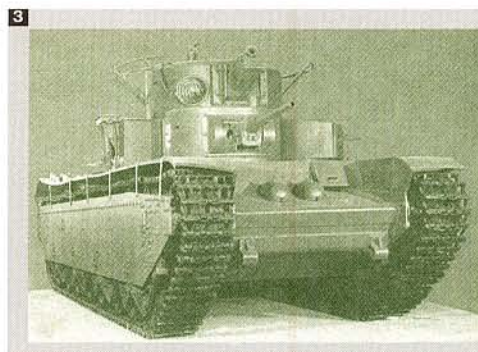
Ведущие колеса заднего расположения со съемными зубчатыми венцами. Направляющие колеса с винтовым механизмом натяжения. Подвеска — на каждом борту по четыре тележки, в каждой по два катка. Подрессоривание осуществлялось двумя спиральными пружинами.
