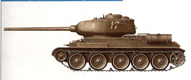
Танк Т-34 образца 1944 г. с 85-мм пушкой ЗИС-С-53
