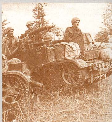
Этот вариант бронетранспортера «Универсал Кэрриер» вооружен пулеметом «Виккерс».
